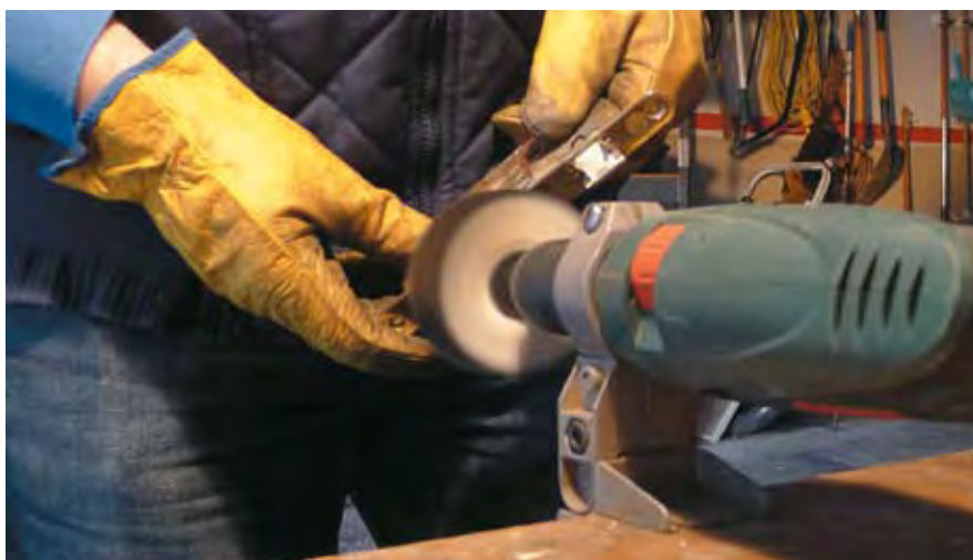
El cepillo de algodón acoplado a la taladradora es el sistema más rápido y eficiente para el pulido amateur del latón
