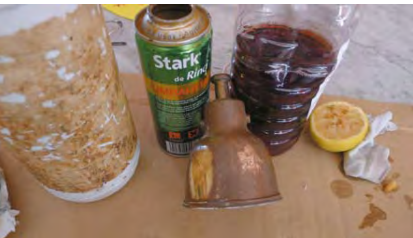
Probamos con limón, vinagre, ácido oxálico y dos tipos de limpiametales. Los vencedores ex-aequo de la prueba "1 Minuto Sacando Brillo" fueron claramente los limpiametales, que consiguieron abrillantar en viejo latón donde los demás métodos apenas descubrían una clapa rosada
