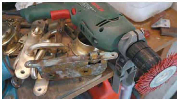
Los cepillos de cerdas plásticas rojas (más blandas que las azules) eliminan el óxido con decisión, pero matizan ligeramente las piezas, que luego requieren un pulido fino
