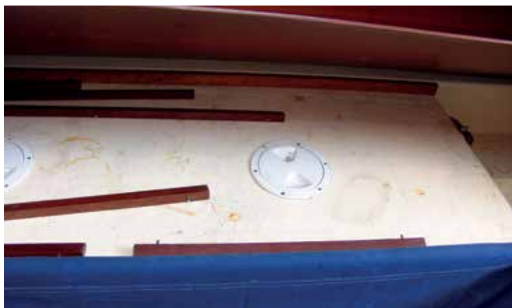
Los depósitos de fibra integrados en el contramolde fueron muy utilizados en los años 70 y 80. Los de la foto corresponden a un Dufour 35
