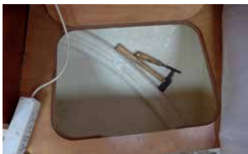
Tras un saneado previo, un par de manos de imprimación epoxy bicomponente Hempel Light Primer devuelve a las sentinas el lozano aspecto de cuando salieron del astillero
