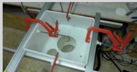
En algún momento antes de 'cerrar' el depósito se han de soldar los paneles de contención, que refuerzan el conjunto e impiden que el líquido coja demasiada inercia con los movimientos del barco
