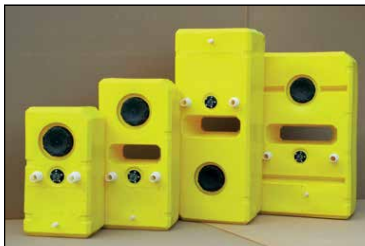
Los depósitos de polietileno existen en diversas formas y tamaños para combustibles, aguas residuales y agua dulce. En la foto, el agujero central en los de mayor tamaño da rigidez al conjunto y hace las funciones de pared de contención
