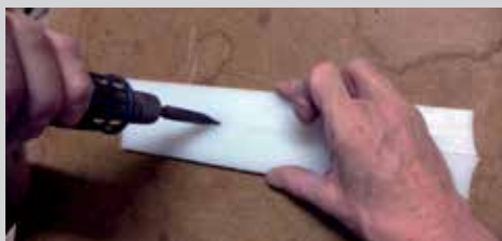
Partiendo de unas medidas sobre papel, de unas plantillas o llevando viejo depósito, es posible realizar una copia exacta en polietileno
