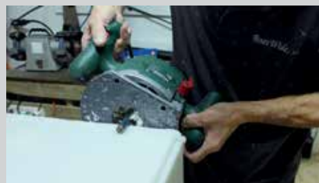
Cuando el polietileno se ha enfriado en las esquinas, la fresadora elimina el material sobrante, dejando los cantos uniformes y romos
