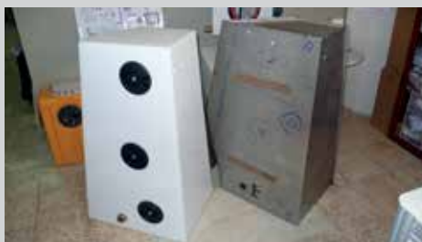
Partiendo de unas medidas sobre papel, de unas plantillas o llevando viejo depósito, es posible realizar una copia exacta en polietileno
