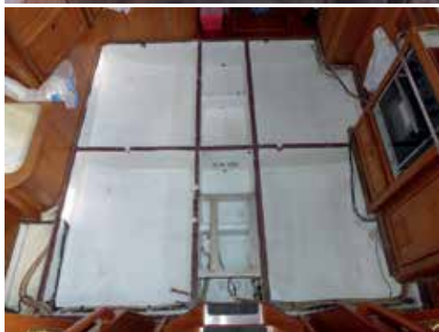
Tras un saneado previo, un par de manos de imprimación epoxy bicomponente Hempel Light Primer devuelve a las sentinas el lozano aspecto de cuando salieron del astillero
