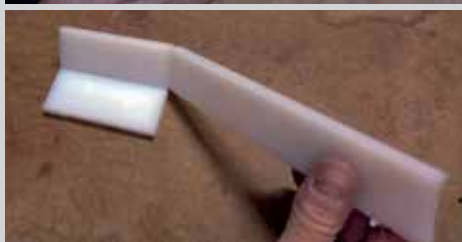
En esta simulación con pequeños retales se ve el proceso de fundir con el soldador una fina lámina de polietileno entre las piezas. Esta fina y flexible unión hace de 'bisagra' componiendo las formas del tanque
