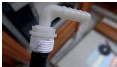
La estanqueidad de los entronques la aseguramos con unas vueltas de cinta de teflón en las roscas. Es importante que el sentido de giro de la cinta sea el mismo que el del apriete
