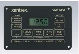
Aparte de indicar el voltaje de las baterías con absoluta precisión, los modernos monitores digitales ofrecen informaciones adicionales sobre el consumo, nivel de recarga y amperaje disponible
