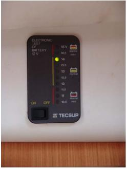
En descanso, las baterías oscilarán entre los 12 v. (mínimo) y 12,80 v. (máximo). En fase de carga, el voltaje puede subir hasta los 14,20 v.. Los monitores ayudan a controlar —visualmente y con alarmas acústicas- estos niveles de tensión.
