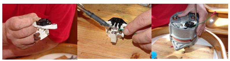
La mayoría de reguladores inteligentes (Adverc, Merlin, Sterling, Xantrex) se "comunican" con el alternador mediante un cable que se ha de soldar. Esta es la operación más delicada en la instalación de este dispositivo.
