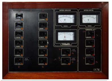
Las indicaciones más importantes en el cuadro son el voltímetro (independiente o seleccionable entre las baterías de motor y servicio) y el amperímetro, testigo del consumo/recarga de los parques.
