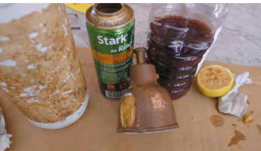
Probamos con limón, vinagre, ácido oxálico y dos tipos de limpiametales. Los vencedores ex-equo de la prueba "1 Minuto Sacando Brillo" fueron claramente los limpiametales, que consiguieron abrillantar en viejo latón donde los demás métodos apenas descubrían una clapa rosada
