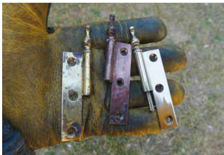
Antes, durante y después de la limpieza y pulido en tres bisagras. Tras pasar por ácido oxálico, la bisagra coge un tono rosado que el posterior pulido vuelve a convertir de dorado brillante
