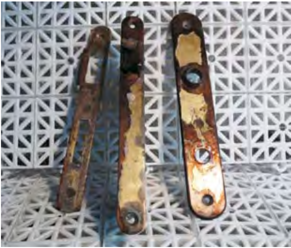
Antes de empezar a pulir se han de eliminar por completo las capas de viejo barniz
