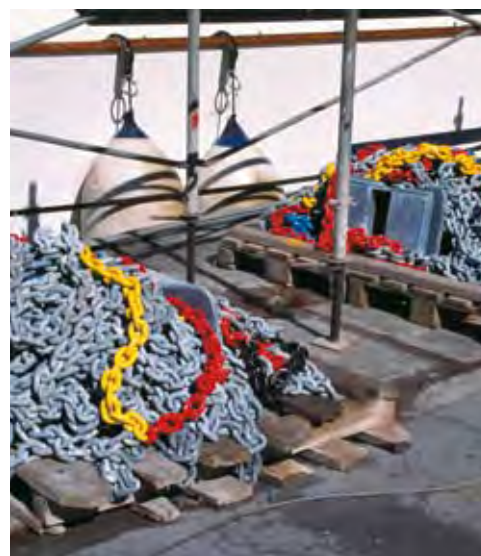
Los fondeos de un gran yate recién pintados con las marcas de distancia. Incluso en estas esloras, el grillete del ancla es una talla superior a la cadena
