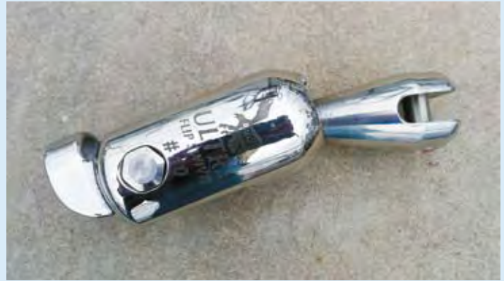
El giratorio Ultra Flip encara el ancla automáticamente en la roldana
