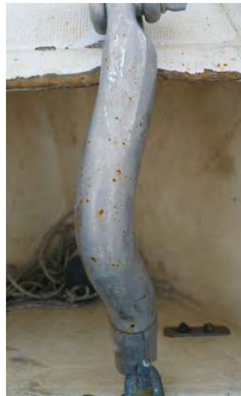
A las pocas semanas de rondar el cofre de anclas, este giratorio de origen asiático presentaba estas feas manchas superficiales de óxido
