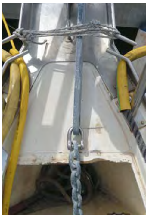
Un grillete corto es la forma más sencilla, fiable y económica de unir el ancla con su cadena. Muy recomendable usar una talla más que el diámetro de la cadena
