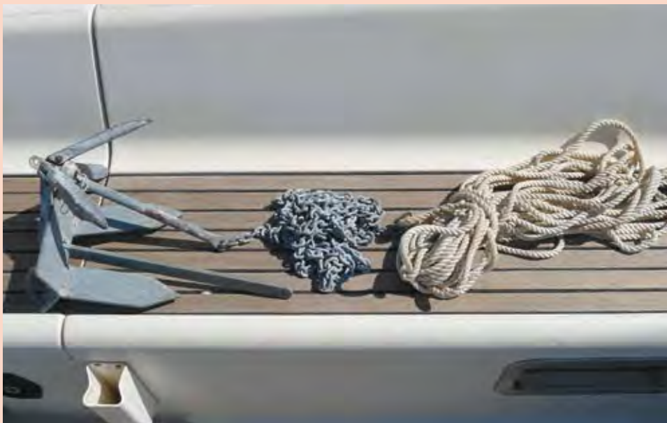
Fondeo ligero por popa compuesto por 20 m. de cabo D10, 5 m. de cadena D6 y dos anclas a alternar según la ocasión
