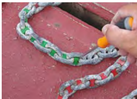
Los dados plásticos son una solución duradera y que se ve muy bien
