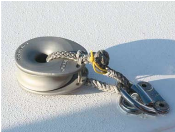
Esta pequeña Karver KBO 6 (67,-€) tiene una carga de trabajo de 600 kilos y sólo pesa 46 gramos
