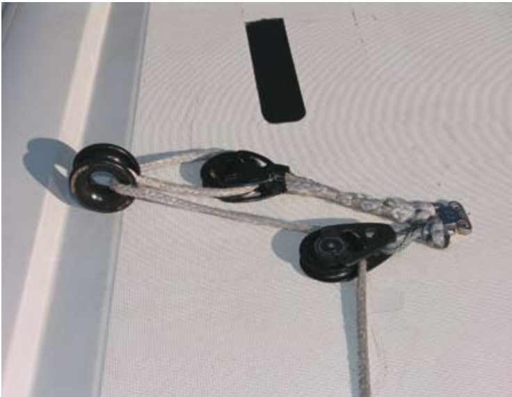
Ejemplo de un barber para escota, con aro de paso en aluminio y reglaje desmultiplicado con control desde la bañera
