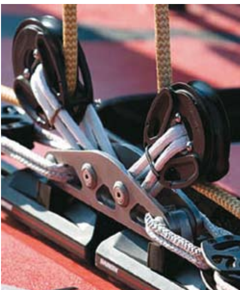
Carro de mayor Harken preparado para el arraigo de poleas mediante gazas hechas con Dyneema
