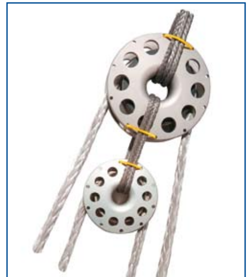
El propio hueco de la polea facilita un doble arraigo para conformar un sistema de violín textil Karver
