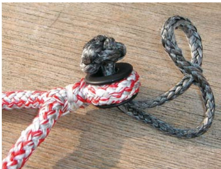
Escota de génova con gaza sobre aluminio pulido y grillete textil: Todo un clásico del acastillaje textil
