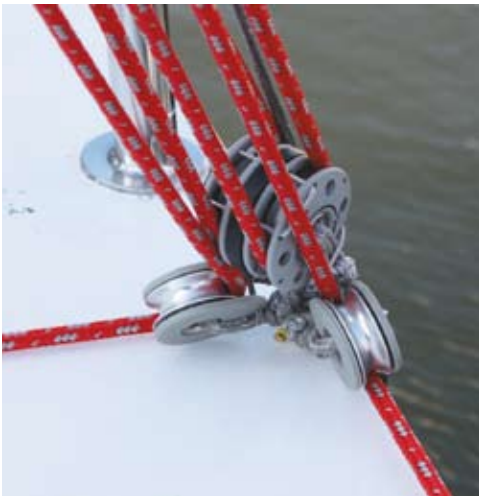
Karver ha ideado un espaciador que se intercala entre las poleas para componer desmultiplicaciones múltiples
