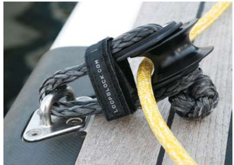
El acastillaje textil evita el molesto ruido de poleas y grilletes golpeando la cubierta. Esta pequeña pasteca Kohlhoff lleva una práctica cincha de seguridad con velcro
