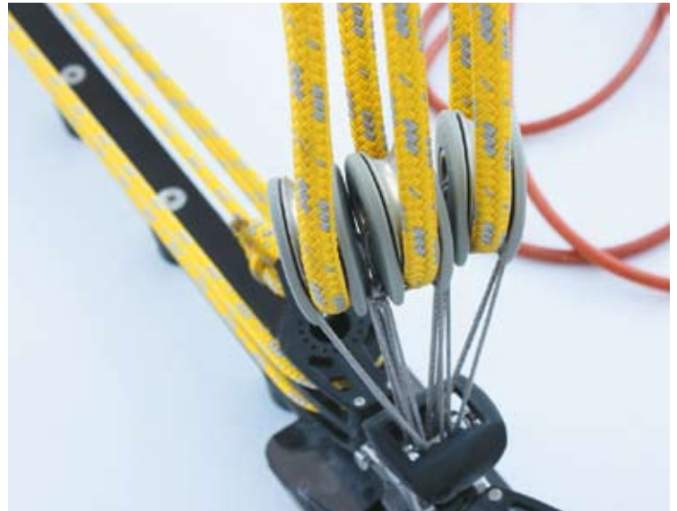
Para conseguir mayor desmultiplicación, estas poleas Karver se han unido lateralmente. El resultado es ligero y efectivo
