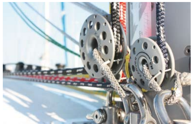
Los grilletes textiles en las poleas de driza aligeran el conjunto sin perjuicio de una excepcional resistencia
